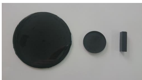
Figura 7- Compósitos em resina epóxi com adição de 10% m/m de fibra de carbono (Torayca M46J, com 5 \mu\text{m} de diâmetro e 9 \mu\Omega\cdot\text{m} de resistividade elétrica)
